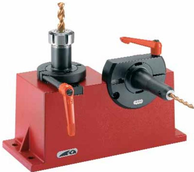
Dieses unkompliziertes System erlaubt die schnelle und sichere Montage und Demontage von Steilkegelaufnahmen in horizontaler und vertikaler Lage. Das Risiko der Werkzeugbeschädigung ist ausgeschlossen. Es eignet sich natürlich auch für modulare HSK-Aufnahmen.
